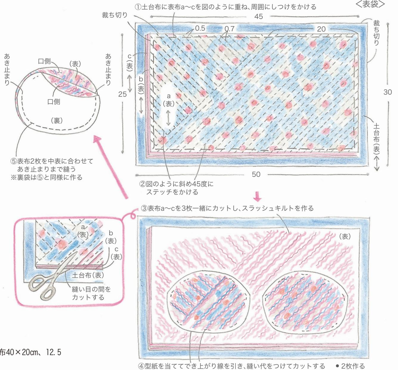
材料(右上) 表布a~c各50×30cm、土台布55×35cm、裏布40×20cm、12.5cm幅×高さ5.5cm両カン付きくし型口金、紙ひも。
